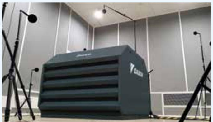
Messung der Schallleistungspegel in einer Akustikkammer
